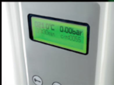
Pantalla LCD permite una mayor facilidad para el operador a la hora de elegir los ciclos de esterilización, un control continuo de las fases del ciclo y la indicación de los errores cometidos por el operador
